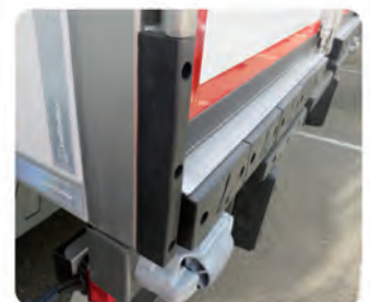
Taco lateral vertical y tacos protegidos por chapa
