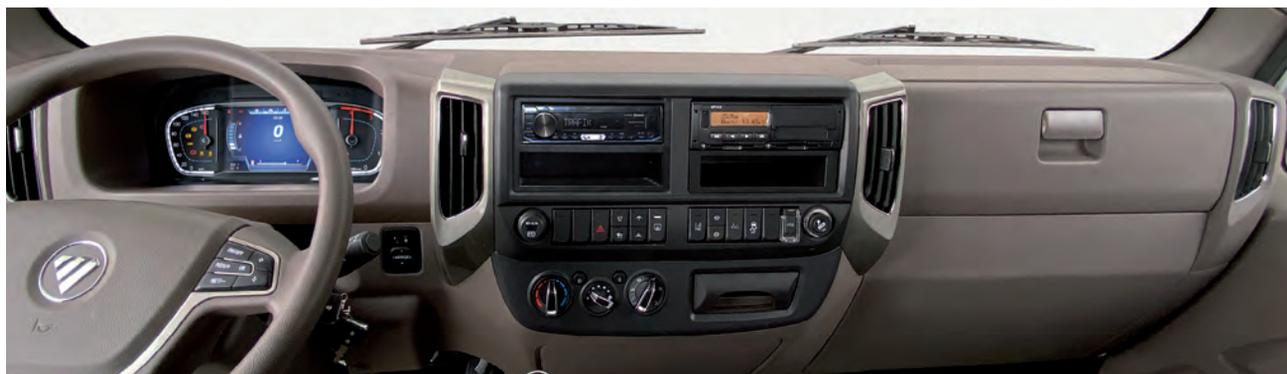
El Otokar Atlas equipa un cuadro con una pantalla digital de 3,2" con dos modos seleccionables y volante multifunción.
