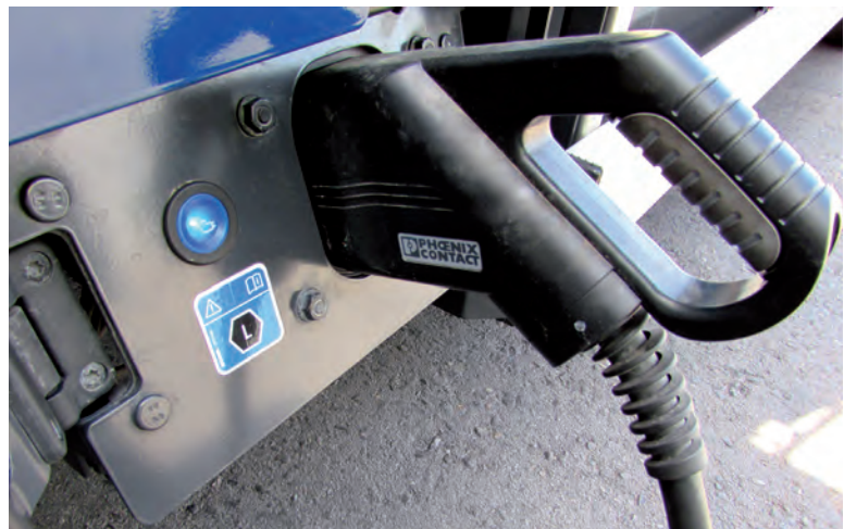
La carga de las baterías puede realizarse en 30 minutos.
