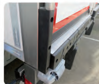
Taco lateral vertical y tacos protegidos por chapa
