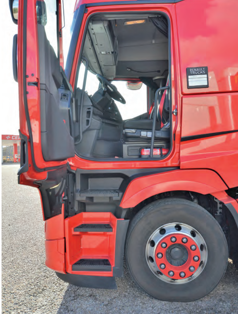
Tres amplios escalones son necesarios para acceder a su interior.
