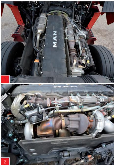
1. El motor D38 de 640 cv destaca por sus prestaciones y bajo consumo.
