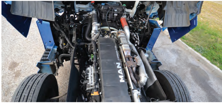
El motor nuevo D2676 ha demostrado su buen comportamiento durante nuestra prueba. Monta una válvula EGR de nueva generación.
