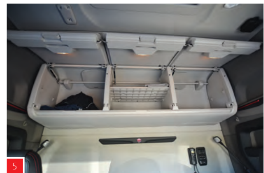
5. Los armarios traseros tienen un volumen total de 300 litros. A lo que hay que sumar los 225 litros de los delanteros.
