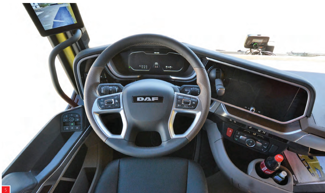
5. El nuevo puesto de conducción está totalmente digitalizado. Cuenta con un cuadro de relojes de 12" y un sistema de infoentretenimiento de 10,1".
