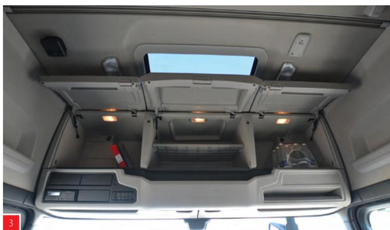
3. La cabina Highline dispone de un volumen total de 235 litros en los armarios delanteros.
