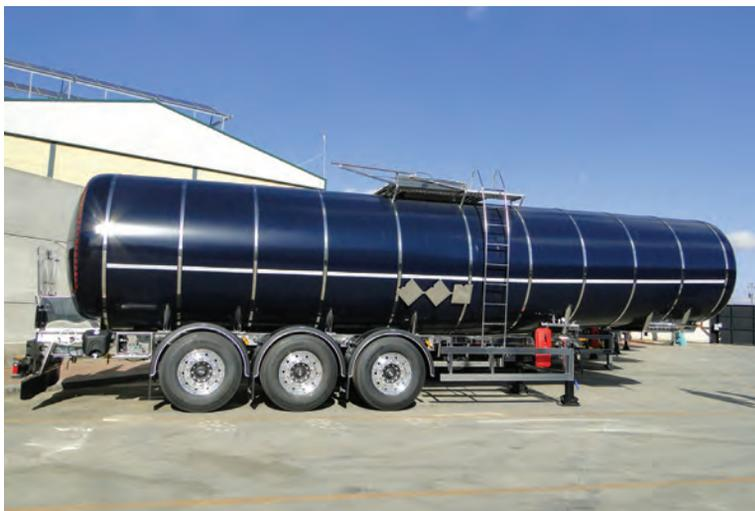
porte por vía marítima. Entre sus características principales, destaca la preinstalación para seis resistencias eléctricas y termostato, pasarela y barandilla situadas alrededor del cajón antiderrame y medidas de seguridad mediante un sistema de seguridad accionado neumáticamente con apertura secuencial, detección de parking accionado y manguera conectada.
