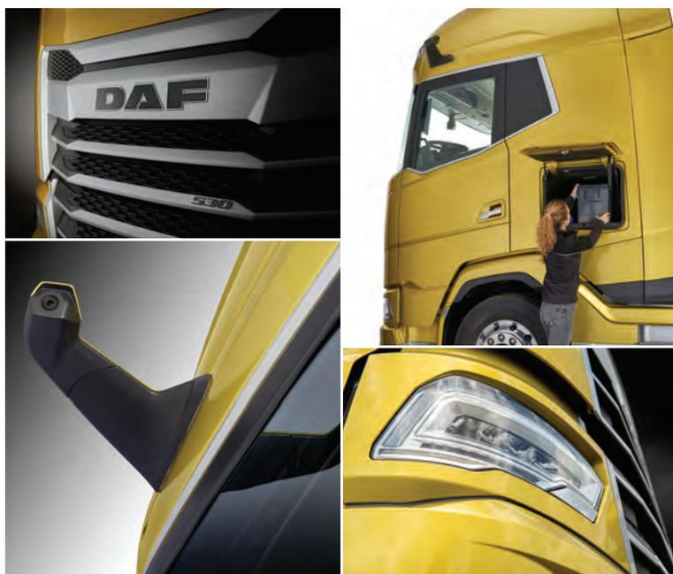
El diseño exterior está muy cuidado. Destaca el sistema DAF Digital Vision System, que sustituye los retrovisores principales. Las cámaras mejoran aún más la visión directa, al tiempo que aumentan el rendimiento aerodinámico.
