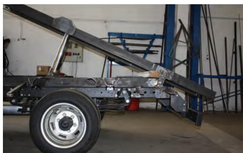
**SI ACTUALMENTE LOS TRAVESAÑOS DE PROTECCIÓN DEBEN TENER AL MENOS 100 MM DE ALTURA, DESDE SEPTIEMBRE TENDRÁN 120 MM Y SI ANTES SUPERABAN EN UN ENSAYO UNA CARGA DE 10.000 KG, AHORA DEBERÁN RESISTIR 18.000 KG**
