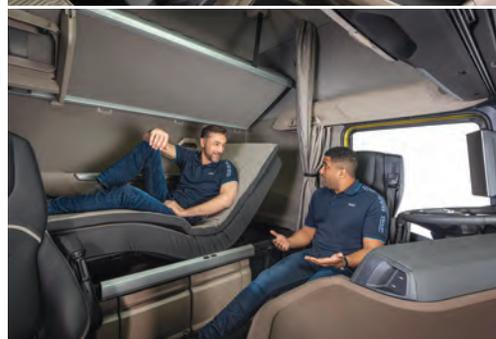
En el interior, la renovación es profunda. El nuevo salpicadero cuenta con dos pantallas de 10" y 12". Para garantizar un perfecto descanso, la longitud de las literas es de 2220 mm en todas las versiones, con una anchura mínima de 800 mm en los modelos XG y XG+.
