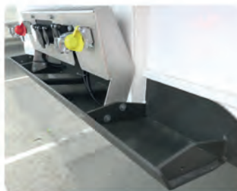
Soporte de conexiones inox y tope delantero de protección XLarge reforzado
