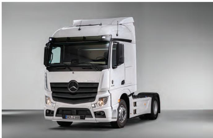
el nuevo Actros en el primer camión producido de serie en el mundo en ser capaz de conducir parcialmente automatizado (nivel 2 de SAE). Apoya activamente al conductor en la guía longitudinal y lateral del camión y puede mantener automáticamente la distancia con el vehículo que le precede, acelerar y también dirigir si se cumplen las condiciones necesarias del sistema, como un radio de curva suficiente o marcas de carretera claramente visibles.
