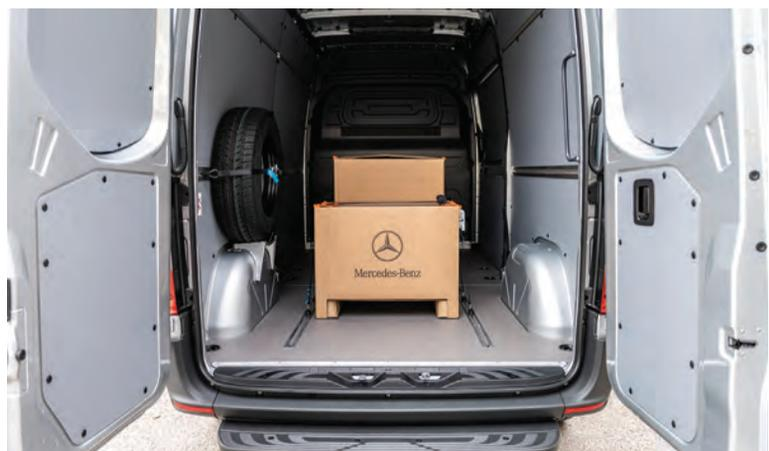
La capacidad de carga máxima es de 1.038 kilos y el volumen de 11 m<sup>3</sup>.
