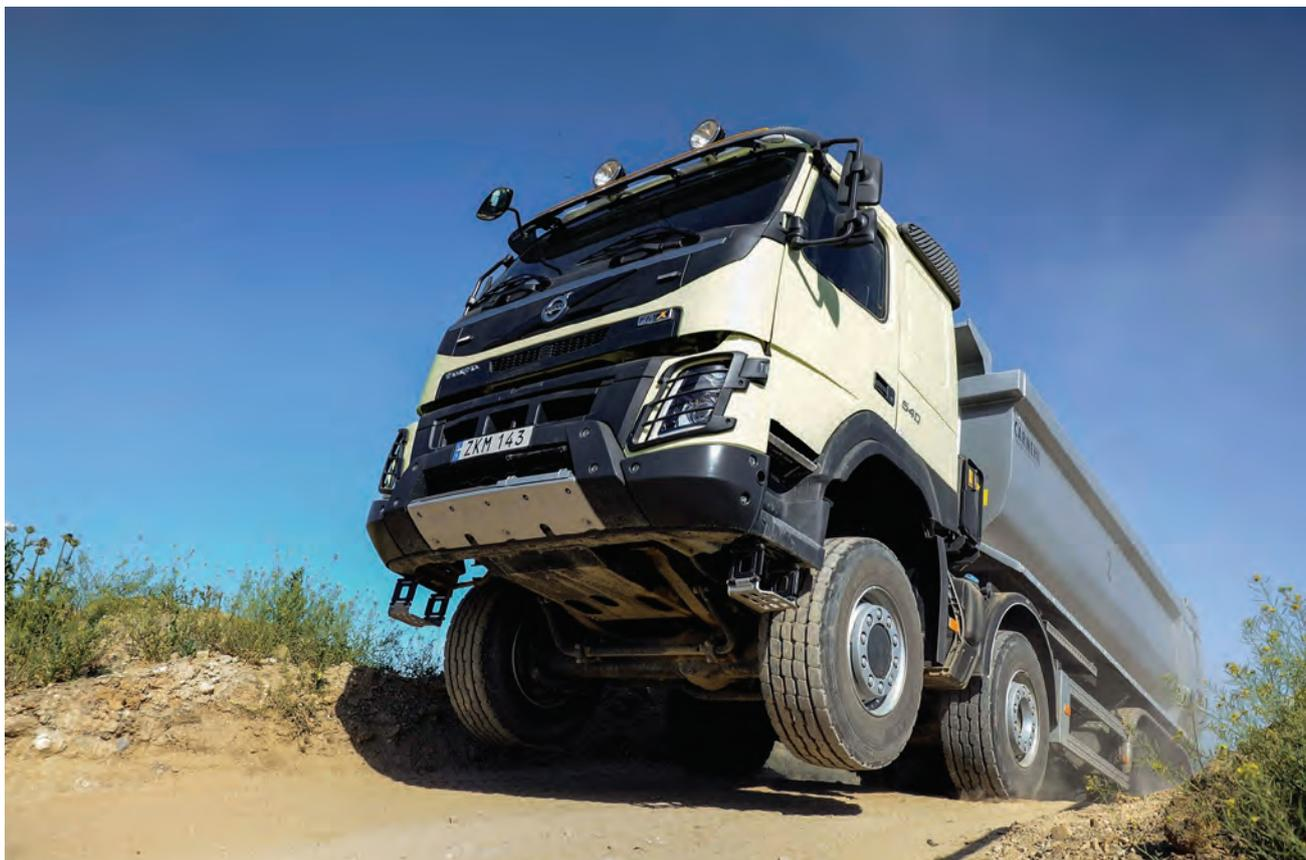
proporciona potencia más que suficiente para mantener un buen ritmo de trabajo. Otras características a destacar en este FMX es el eje motriz elevable además de una caja de cambios I-shift con doble embrague. En estos dos vehículos la carga por eje es idéntica: 9 t para el eje delantero y 33 t para el trasero.
