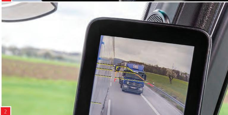
1. Las cámaras del sistema MirrorCam situadas en la parte superior de la cabina sustituyen a los retrovisores.
